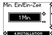
Рис. 5. Отработка функции минимального времени между двумя включениями
