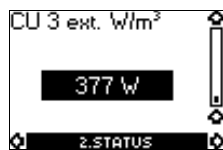
Рис. 11. Фактически потребляемая мощность из расчета на 1 м 3 перекачиваемой жидкости На рис. 11 приведено дисплейное изображение фактически потребляемой мощности из расчета на 1 м 3 перекачиваемой жидкости (кВт/м 3 )
