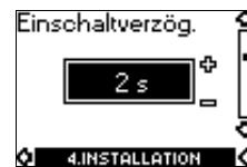
Рис. 4. Отработка выдержки времени включения Функция, показанная на дисплейном изображении на рис. 4, впервые срабатывает, в том случае, когда подключается напряжение сети и после исчезновения напряжения. Эта функция полезна, когда несколько электродвигателей подключено к одному и тому же напряжению сети.
