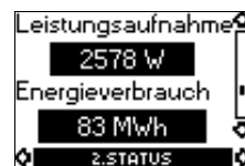
Рис. 8. Фактическая потребляемая мощность и общее энергопотребление электродвигателем с момента его установки
