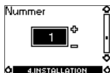
Рис. 8. Присвоение адреса блоку защиты CU 3. На дисплейном изображении, показанном на рис. 8, каждому блоку защиты CU 3 можно присвоить адрес в виде номера от 1 до 64 либо изменить этот номер.
