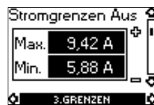
Рис. 2. Пороги отключения для верхних и для нижних значений тока
