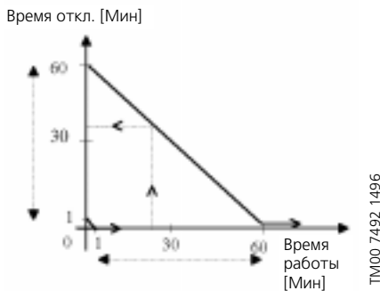
Рис. 36. Зависимость времени отключения насоса от времени его работы
