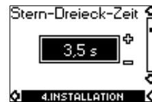
Рис. 3. Установка времени включения электродвигателя в соединении звездой и в соединении треугольником
